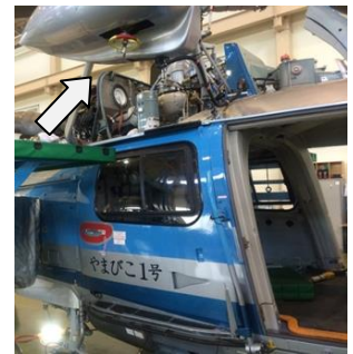
Fig.1 矢印がつり上げ装置(ホイスト)。中にワイヤーが入っている。「やまびこ 1号」と記載されている側面ドアが左にスライドするが間口は狭い。右の開いているドアは飛行中閉鎖している。
