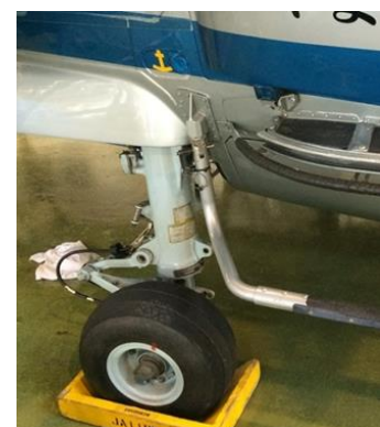
Fig.5 タイヤ式着陸装置、3 か所で機体を支える。エンジン停止で全重量をかけると、沈み込む構造。接地面からの高さを維持するにはメインローターを回し続ける。
