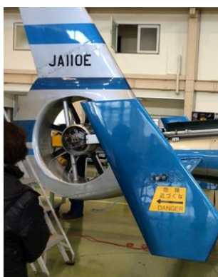
Fig.3 回転するテイルローターは小石を巻き込むリスクがある。奥から手前側に空気が高速で移動する。
